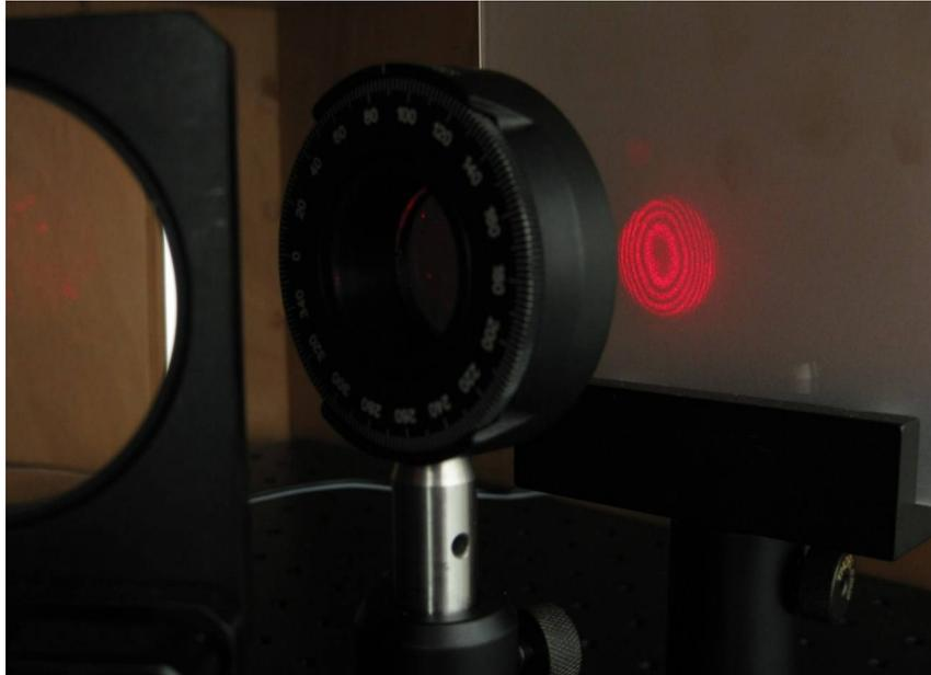
Abb. 8: Interferenzmuster hinter dem "Radierer"
