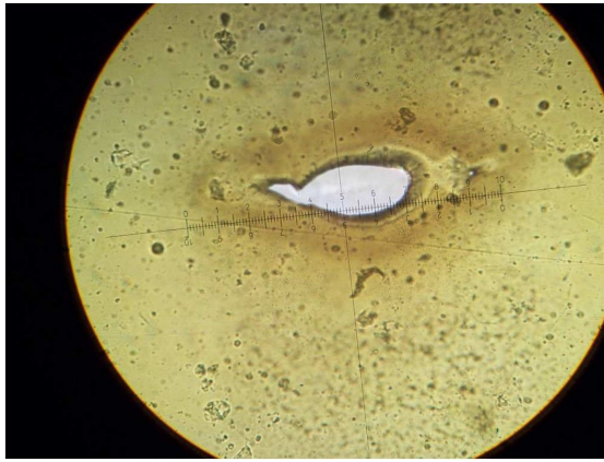
Abbildung 4: Ein Loch in einer Kaptonfolie mit umgebender Corona
