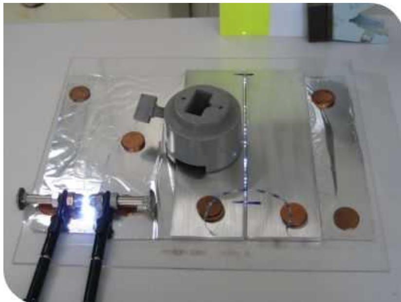
Abbildung 1: Prototyp des Stickstofflasers
