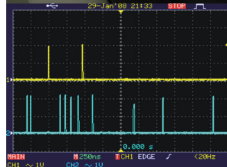
Oszilloskopaufnahme mit Einzelphotonen
