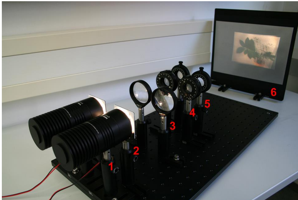
Fig. 2: Unser 3D Aufbau mit realD™ Technik mit zirkular polarisiertem Licht
