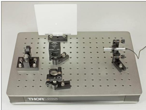
**Schritt 3:** Stellen Sie den zweiten Spiegel an seine Position. Die beiden Arme des Interferometers sollten möglichst gleich lang sein. Am Schirm sollten Sie nun zwei Laserpunkte sehen.
