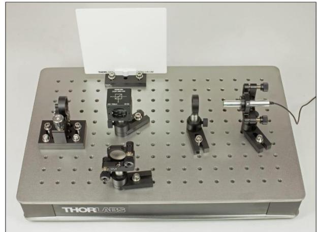
**Schritt 4:** Stellen Sie die Aufweitungslinse direkt hinter den Laser (einige Millimeter oder wenige Zentimeter vom Laser entfernt). Sie sollten nun ein Ring- oder ein Streifenmuster sehen.
