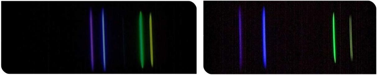
Abbildung 2: Einfluss der Gitterkonstante: Bei Benutzung eines Gitters mit  $g = 600$  Strichen pro Millimeter (linkes Bild) können die beiden gelben Spektrallinien nicht getrennt werden. Verwendet man hingegen ein Gitters mit  $g = 1200$  Strichen pro Millimeter (rechtes Bild) könne sie aufgelöst werden.
